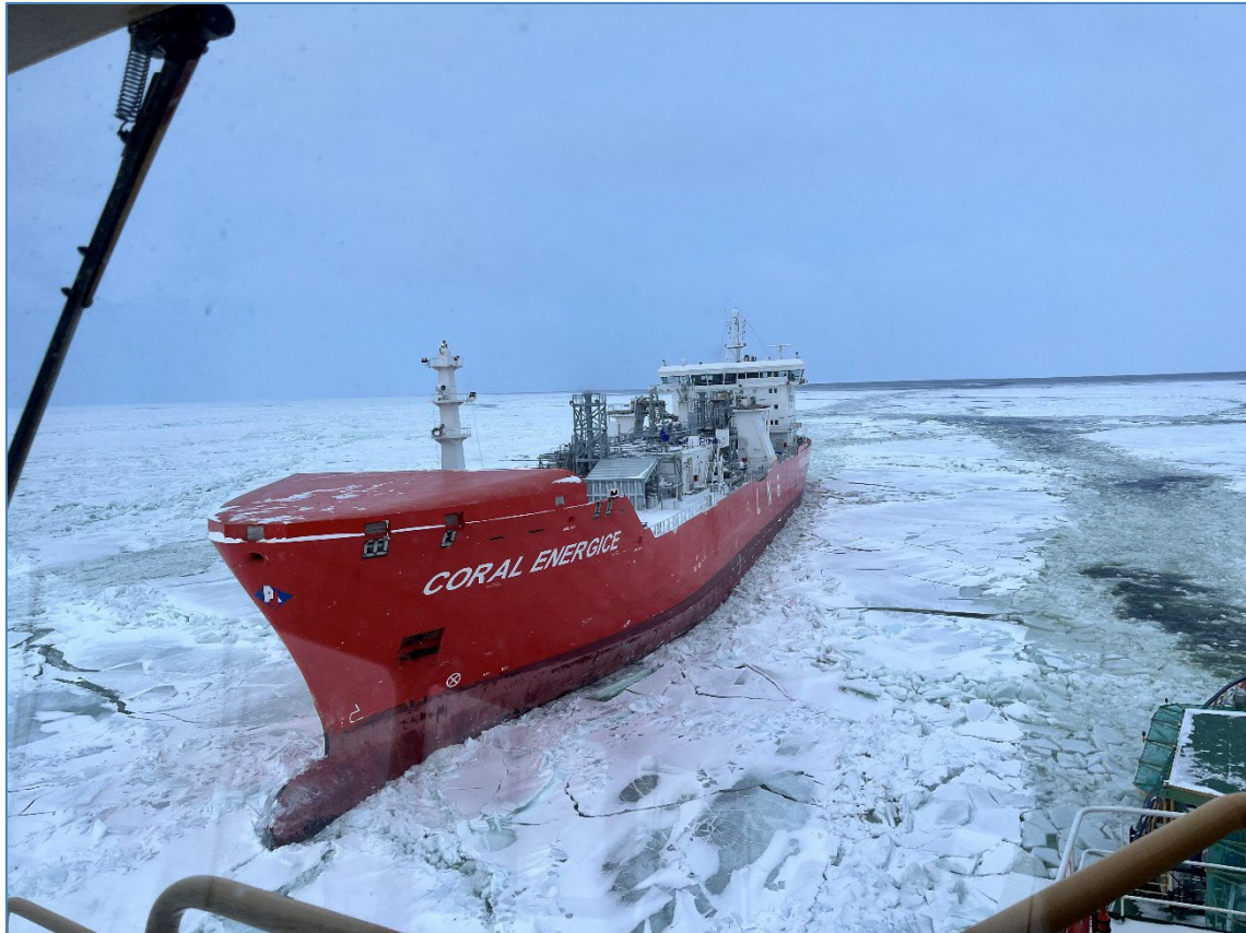
Figur 5 Isbrytare bryter loss fartyg som fastnat i isen med s.k. Quarter pass. Notera sprickbildningen från den uppbrutna rännan mot fartygets förstäv.
