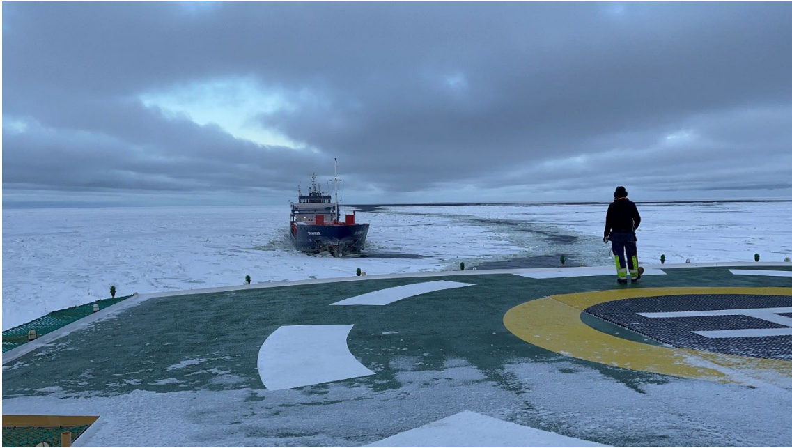
Figur 6 Isbrytare som genomfört en Quarter pass. Assisterade fartyget kan med fullt påslag i maskin nyttja sprickorna och tränga sig ut i den uppbrutna rännan.
