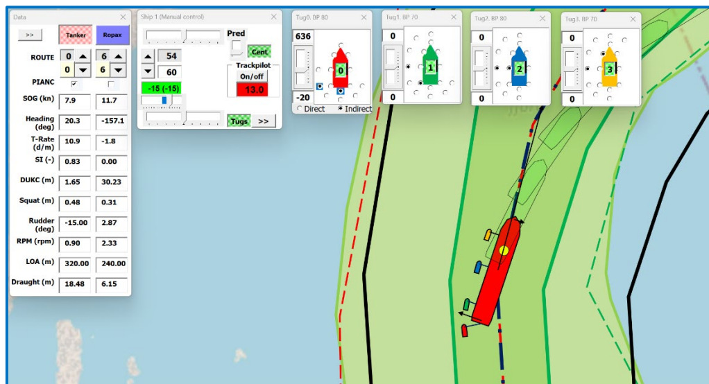
Figur 12 Programinterface för ShipsandfairwaysII som använts för desktopsimuleringar. I bilden syns det manuellt styrda fartyget (rött) och dess prediktor vid en gir i farleden. Fyra bogserbåtar verkar som krafter på hennes babordssida (nr 0-3).
