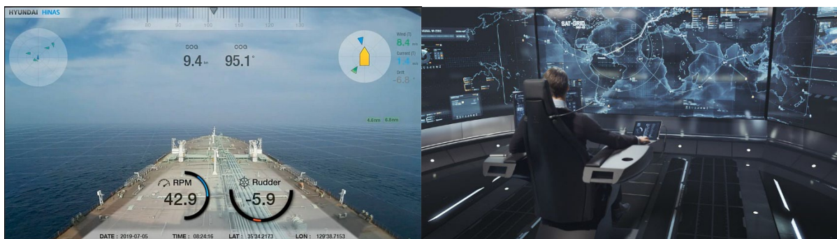
Bild 8, visar ett AR system Hi-NAS och en fjärroperationscenter (Joohyun Woo, 2019 & Rolls-Royce 2016).
