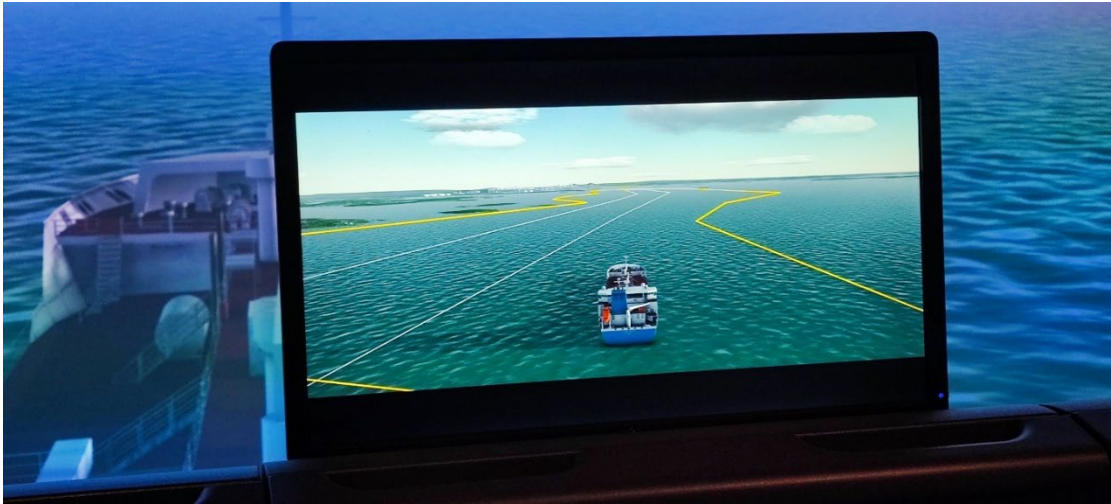
Figur 24 Exempel på dynamiska fartygskorridorer baserat på fartygens säkerhetsdjupgående, vattenstånd och högupplösta sjökort (S-100). Den vitmarkerade korridoren exemplifierar mötande fartygs utrymme.
