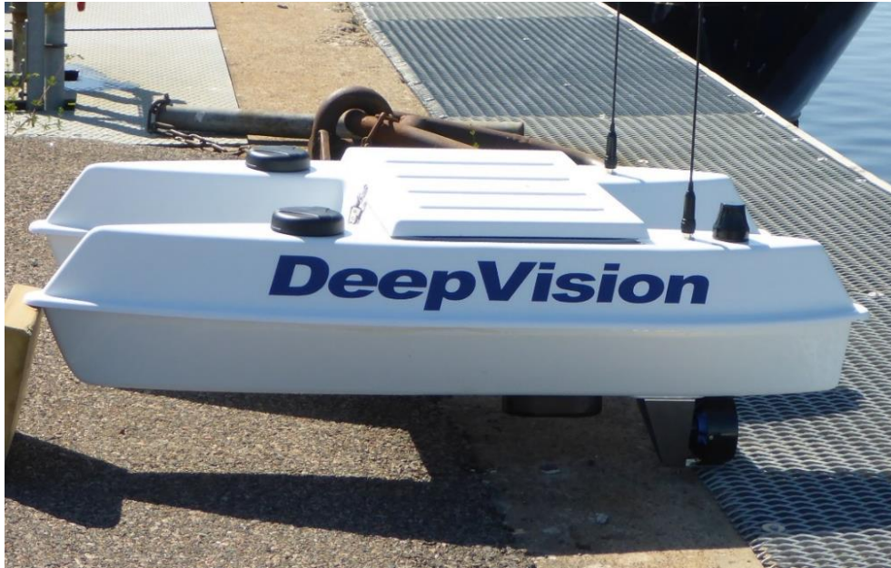
Figur 4-3. Den autonoma mätenheten Skräddaren (DeepVision).
