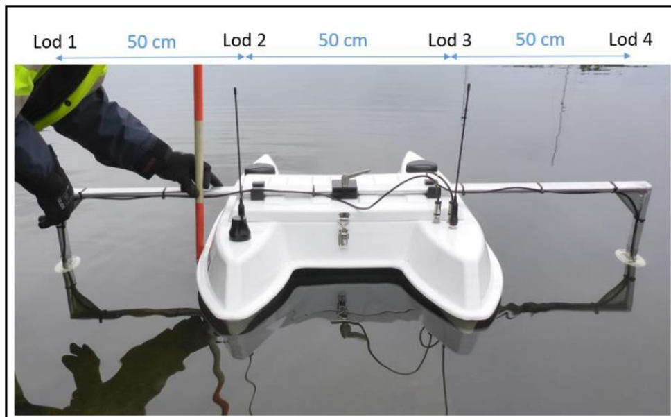
Figur 5-15. Skräddaren visad bakifrån uppdaterad med totalt fyra ekolod.
