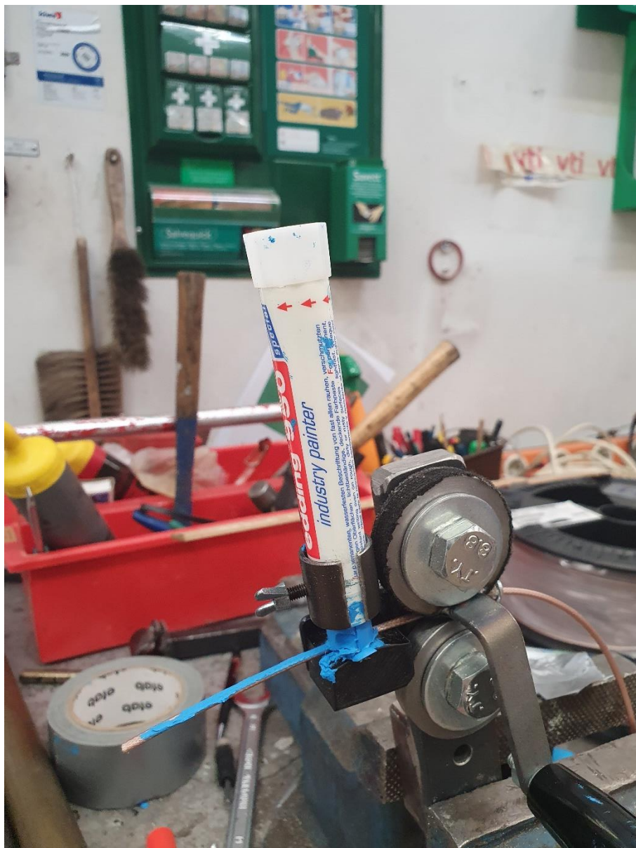
Figur 30. Tillplattning av kabel.
