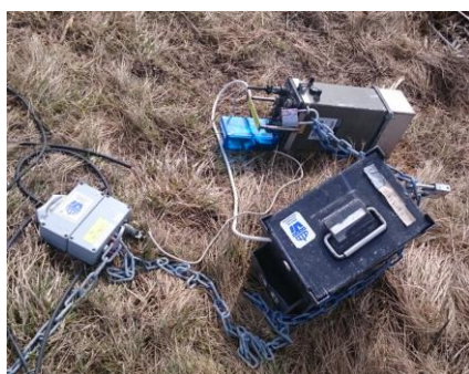
Figur 5. Sensorförstärkare, trafikanalysator, batteri.
