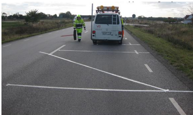
Figur 1. Mätning av sidoläge med tejpade sensorer.
