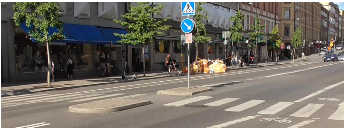
Figur 3.3 Övergångsställe med mittrefug längs Hornsgatan, Stockholm.
