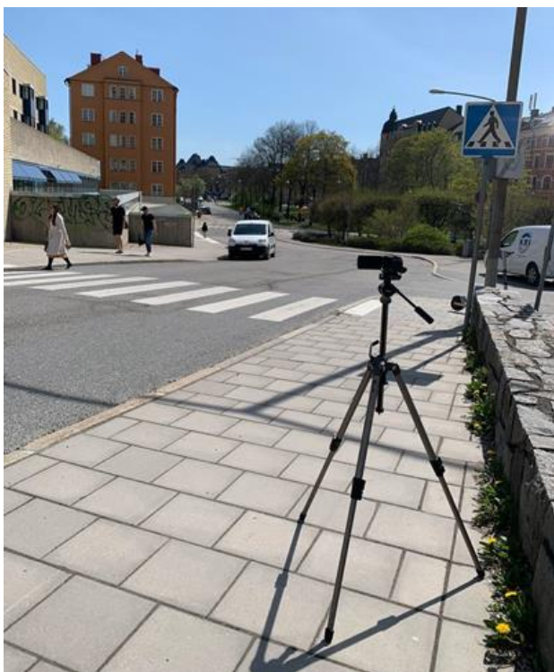
Figur 4.1 Exempelbild på uppställning av en filmkamera vid en mätplats.
