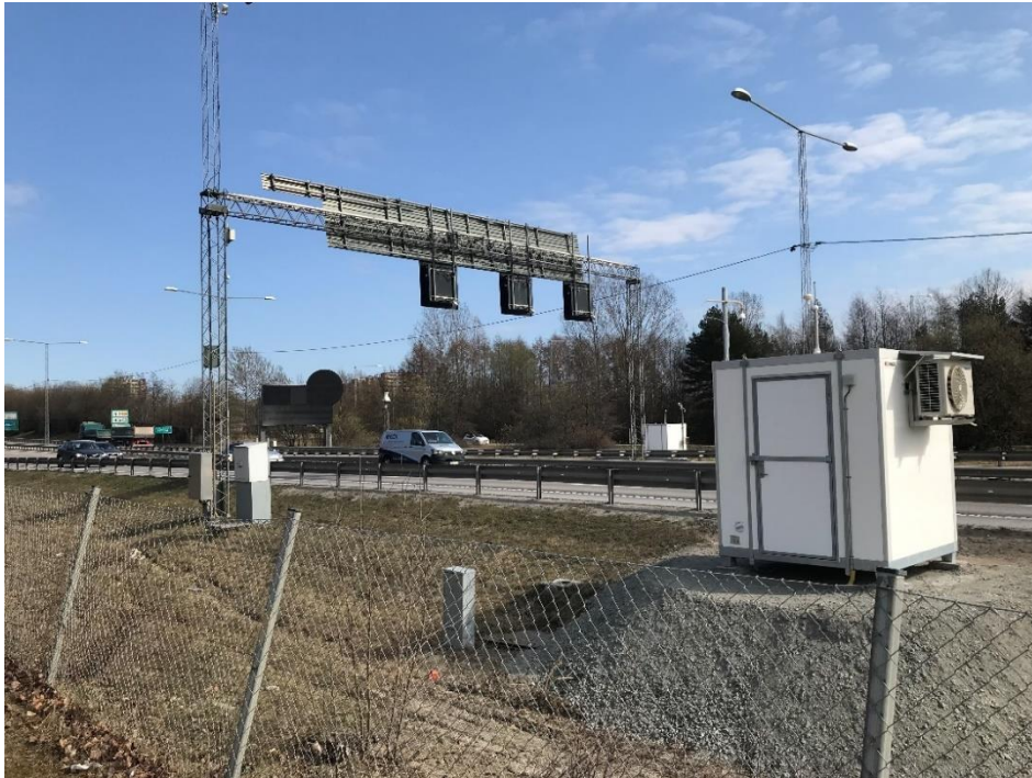
Figur 20. De två mätstationerna intill E4/E20 vid Hallunda. På bilden syns även baksidan på några av de portaler som visar den gällande hastigheten samt den informationsskylt som var tänkt att ge information till trafikanterna.
