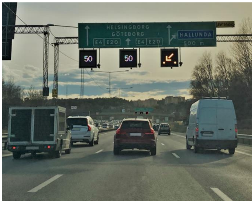
Figur 2. En vägportal som tillhör trafikledningssystemet. Rekommenderade hastigheter samt pil visas i körfältssignaler..
