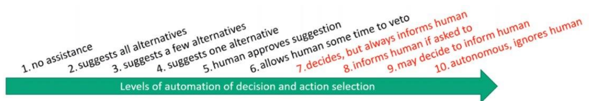
Figur 3 Automatiseringsnivåer för ett mer sofistikerat brandsystem.
