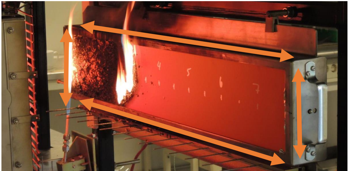
Figur 14. Proving av reaktion vid brandpåverkan enligt FTP-koden, part 5.
