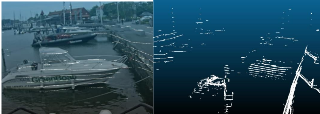
Figur 10 Visualisering av LIDAR-data i 3D vertikal projektion, bilden till vänster innehåller data från en skanning och bilden till höger innehåller data från tio skanningar.
