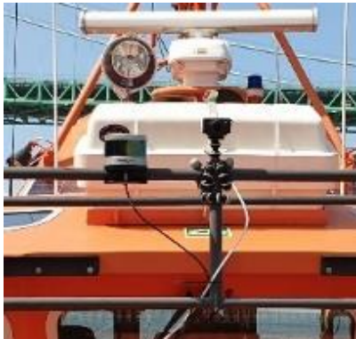
Figur 7 LIDAR och optisk kamerauppsättningsinstallation på lotsbåt.
