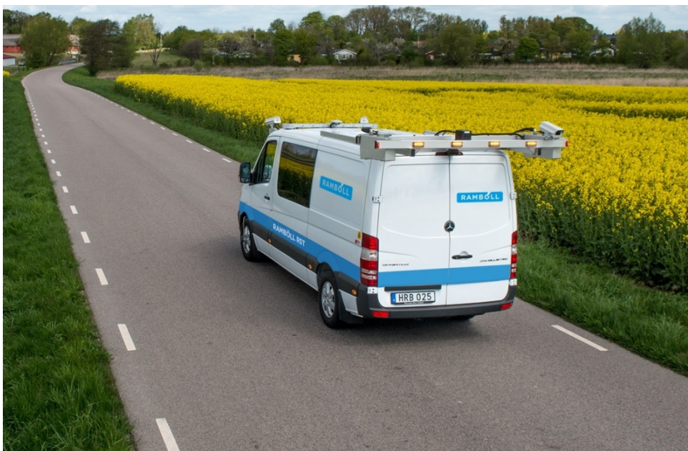
Figur 1 RST57 med linjelasern av typen LCMS-1 monterad baktill på fordonet. Foto: Ramboll
