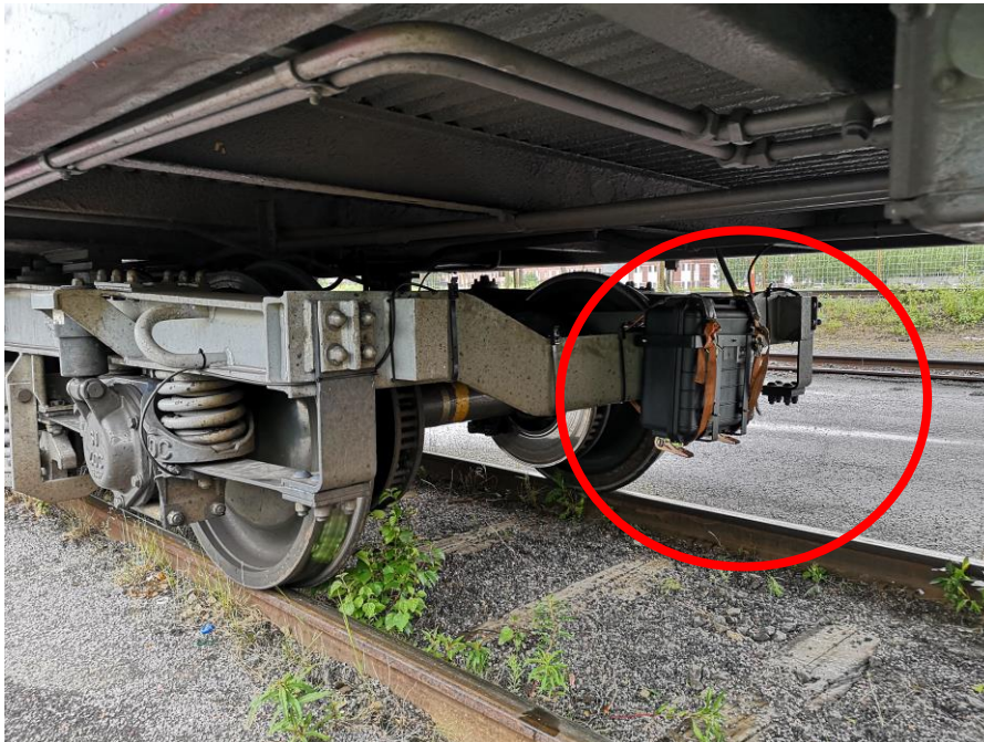
Figur 2: Track Logger monterad på en av SJ:s personvagnar.
