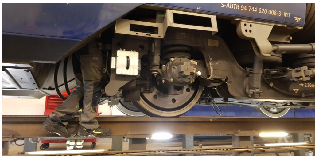
Figur 3. D-Rail monterad på Tågkompaniets tåg. Den silvriga lådan, på axelboxen syns även en silvrig mätpunkt.
