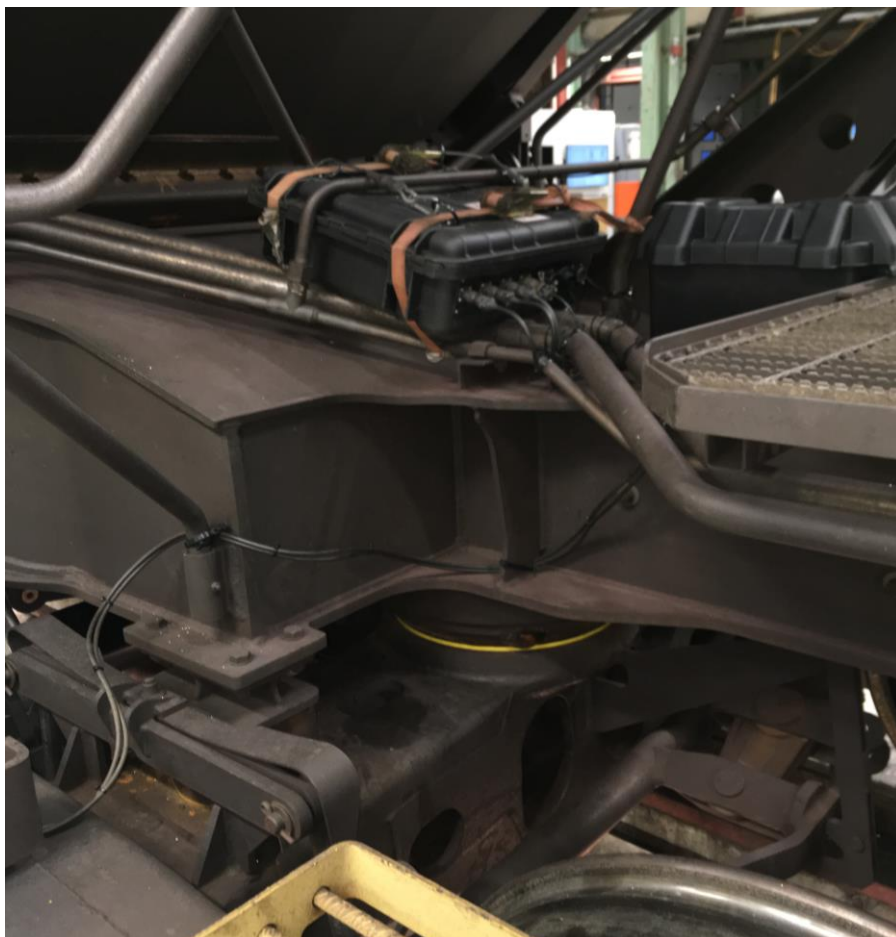
Figur 1: Montage av TrackLogger på en av LKAB:s malmvagnar avsedd att trafikera sträckan Kiruna – Narvik.
