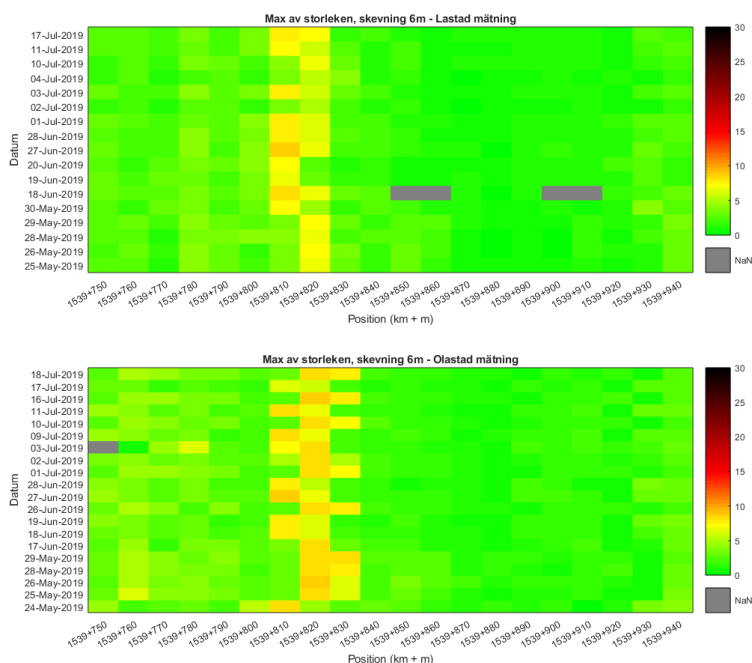
Figur 14: Maxvärdet av storleken för skevning 6m på en 200 meters sträcka under perioden 2019-05-24 till 2019-07-11. Maxvärdet är beräknat för 10 m intervall på sträckan. För de gråmarkerade positionerna (NaN) saknas mätvärden. Den övre figuren visar mätningar gjorda då malmvagnen varit lastad och den undre då vagnen varit olastad.
