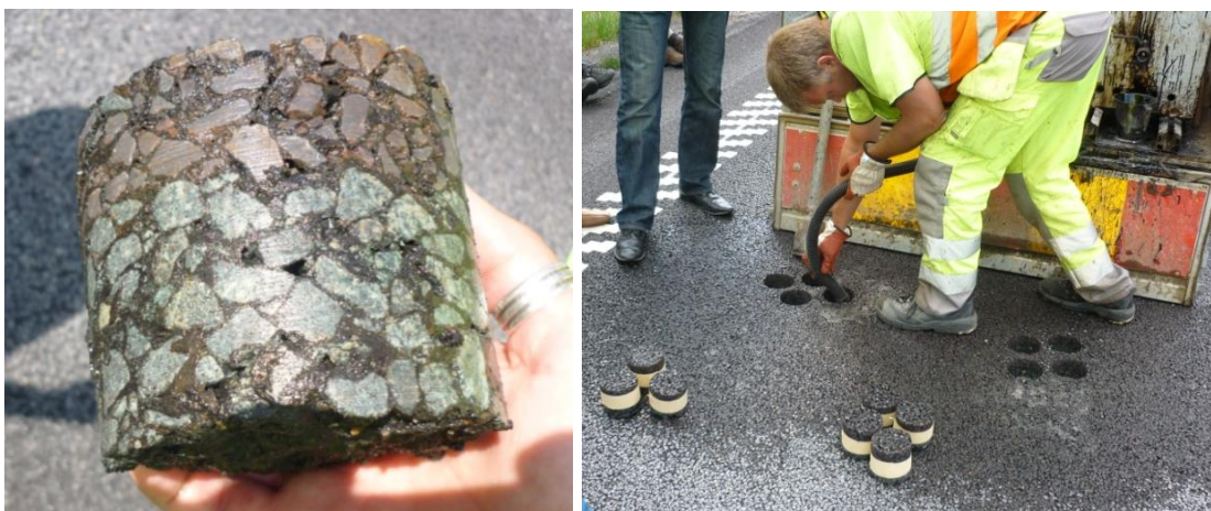
Bild 11. Provtagning av borrhärnor, E 4 Huskvarna, maj 2011.
