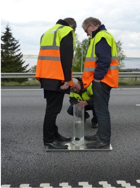
Bild 10. Mätning av dräneringseffekten hos beläggningen genom utrinningstest (2012, 2013 och 2014).
