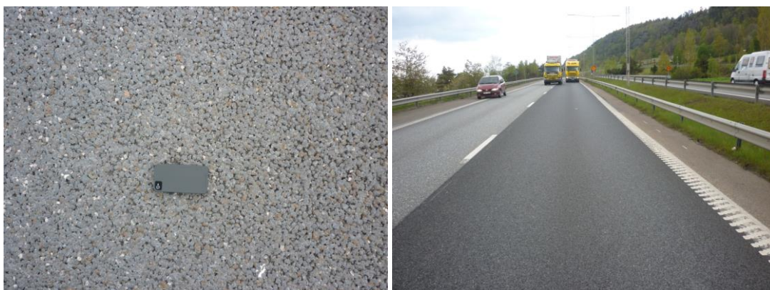
Bild 6. Provsträcka 1 med stålslagg i sorteringen 4/11 mm (2012).
