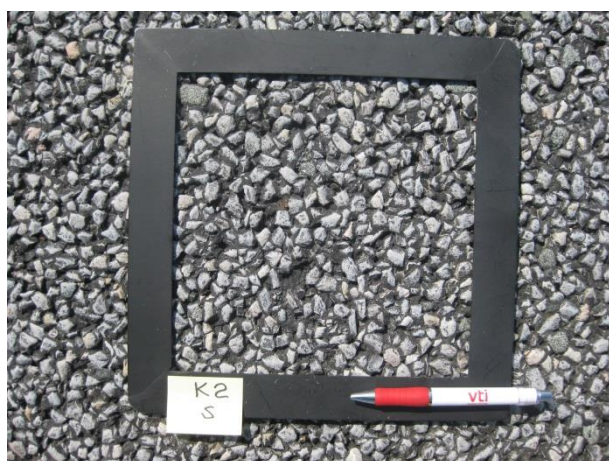
K2 Söderut [dubbeldrän, förhöjd bindemedelshalt] (provsträcka 2)
