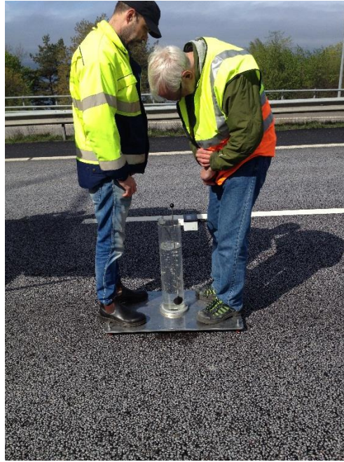
Bild 10. Mätning av dräneringseffekten hos beläggningen genom utrinningstest (2012, 2013 och 2014).
