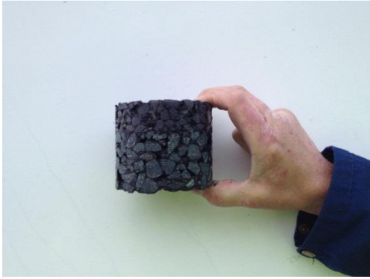
Bild 12. Borrkärna från maj 2014, provsträcka innehållande stålslagg i övre lagret.
