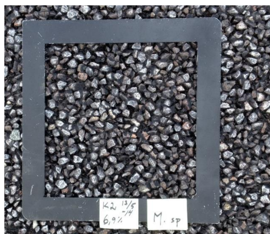
K2 Söderut [dubbeldrän, förhöjd bindemedelshalt] (provsträcka 2)
