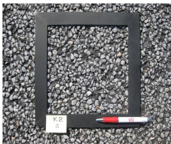
K2 Söderut [dubbeldrän, förhöjd bindemedelshalt] (provsträcka 2)
