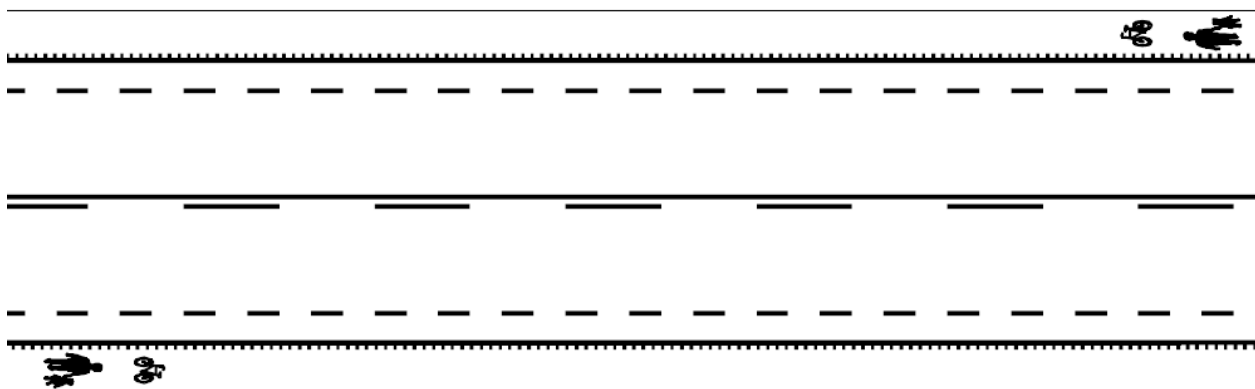
Bild 2. Gång- och cykelbana separerad med varningslinje (M3) samt heldragen linje (M8) med "kamflex". Viktigt med tydlig utmärkning av GC-bana så att den inte misstolkas som "vägren".
