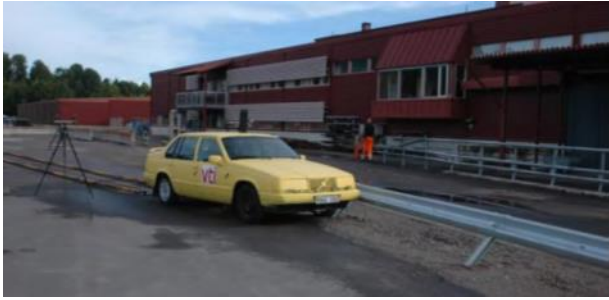
Figur 2. Test fordon vid kollisionspunkten med 20° angreppsvinkel innan kollisionstesten genomförs.
