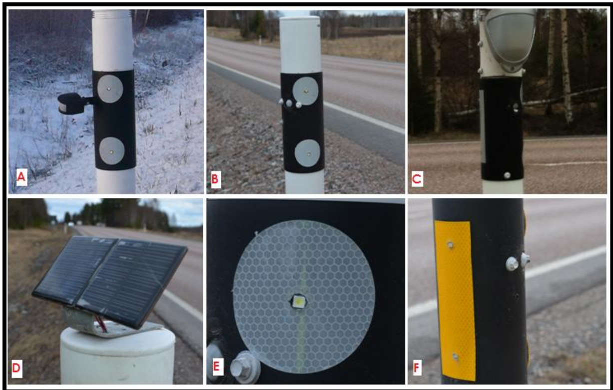
Figur 6 Bilder på viltvarnaren. A: ursprunglig sensor, B: sensorversion 2, C: sensorversion 3, D: solcell, E: vit LED, F: gul LED
