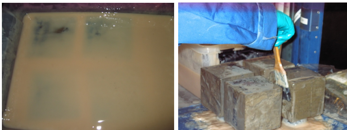
Foto 5: Applicering av impregneringsmedel.
