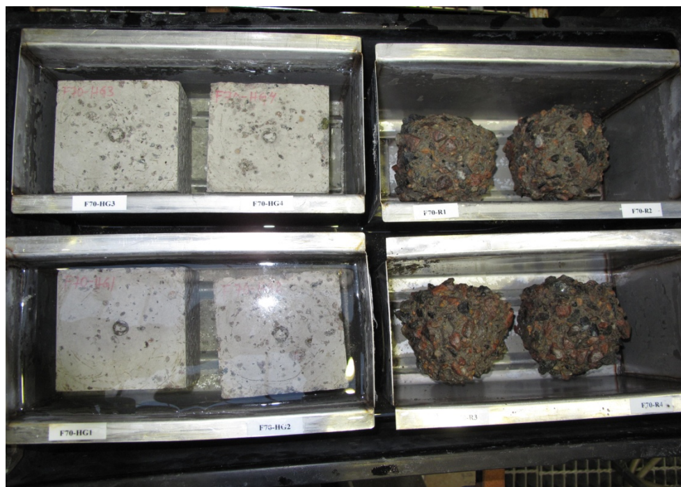
Foto 6: Resultat efter salt-frostprovning (vct 0.70). Fotona till vänster visar provkroppar impregnerade med HG och fotona till höger referensprover.
