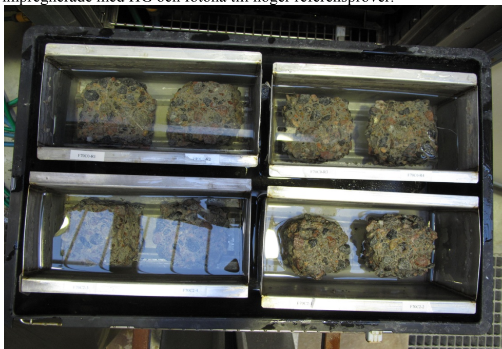
Foto 6: Resultat efter salt-frostprovning (vct 0.70). Fotona till vänster visar provkroppar impregnerade med HG och fotona till höger referensprover.
