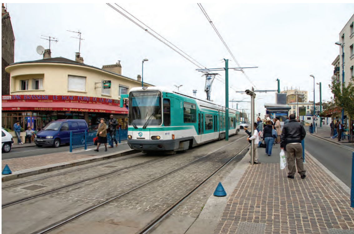
Figur 7 Ändhållplats för spårvägslinje T1 vid RER-stationen Noisy-le-Sec. Notera blå kon på plattformskanten närmast; en del av formspråket (identiteten) för linje T1. Spårvagnsmodellen är ca 30 m lång och 2,30 m bred, med trappor upp till det höga golvet i vagnsändarna. Vagnstypen har för låg kapacitet för den passagerartillströmning som nu gäller för linje T1. (Foto: ©TJ Kommunikation.)
