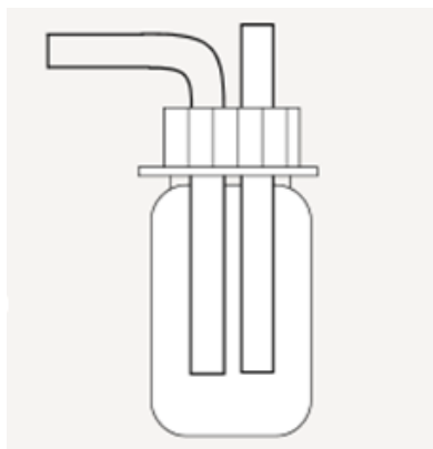
Figur 5. Fluxprovtagaren. Partiklar transporteras in i flaskan med vinden. Innehållet sköljs ut med vatten och suspensionen filtreras och vägs. Vatten och partiklar kan analyseras vidare med avseende på exempelvis metaller.
