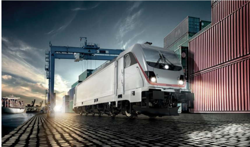
Figur 66. Exempel på ett duolok, Bombardier Traxx last mile, ett elektriskt linjelok som även har en dieselmotor för växling på bangårdar, terminaler och industrispår utan kontaktledning.
