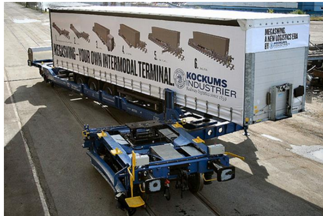
Figur 75. Kockums Megaswing-vagn med möjlighet till överföring av påhängsvagnar. (Foto: Kockums Industrier)
