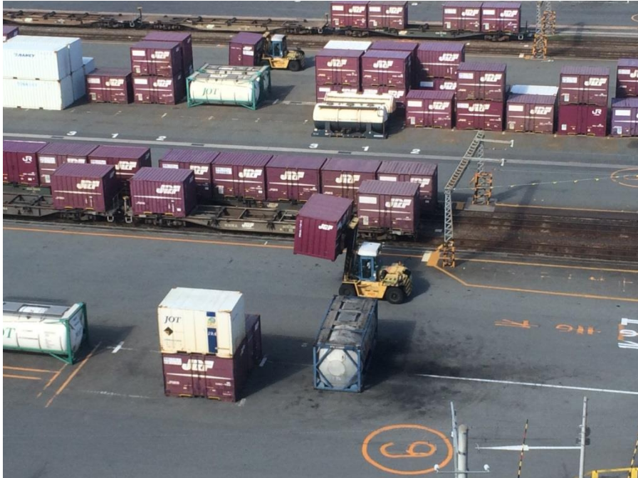
Figur 73. Omlastning av containrar med gaffeltruck i 'Tokyo Freight Terminal', Shinagawa, Tokyo (Foto: Behzad Kordnejad, 2015)
