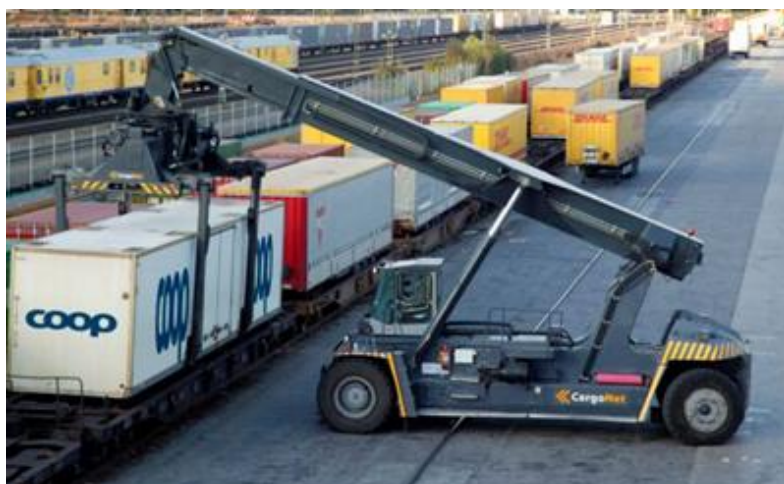
Figur 69. Griparmslyftning med en reach-stacker truck (Foto: Coop)
