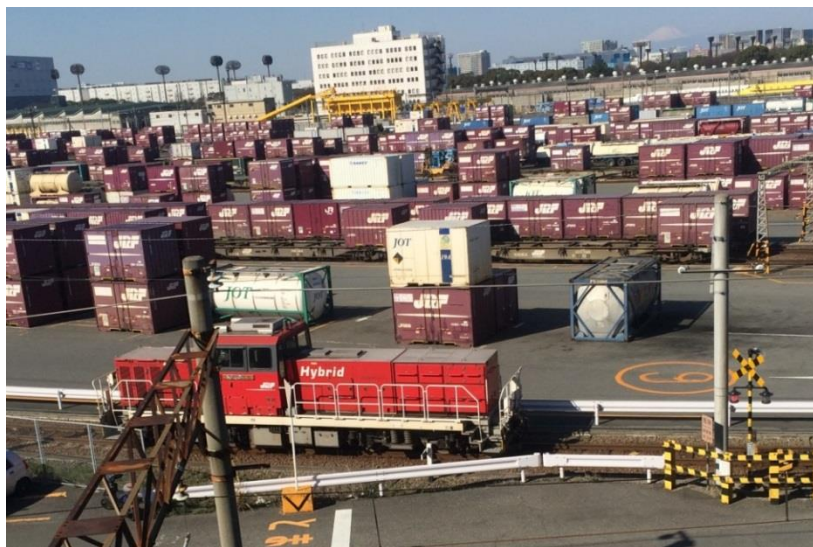
Figur 67. Exempel på hybridlok, ett tungt växlingslok med diesel- och batteridrift. Shinagawa, Tokyo. 2015 (Foto: Kordnejad, 2015)
