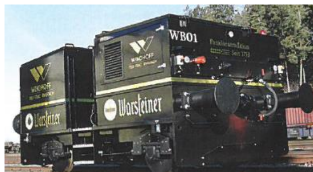
Figur 68. Exempel på batterilok: Teletrac RW60AEM – ett mindre växlingslok som är batteridrivet och radiostyrt (Railway Gazette, April 2017).
