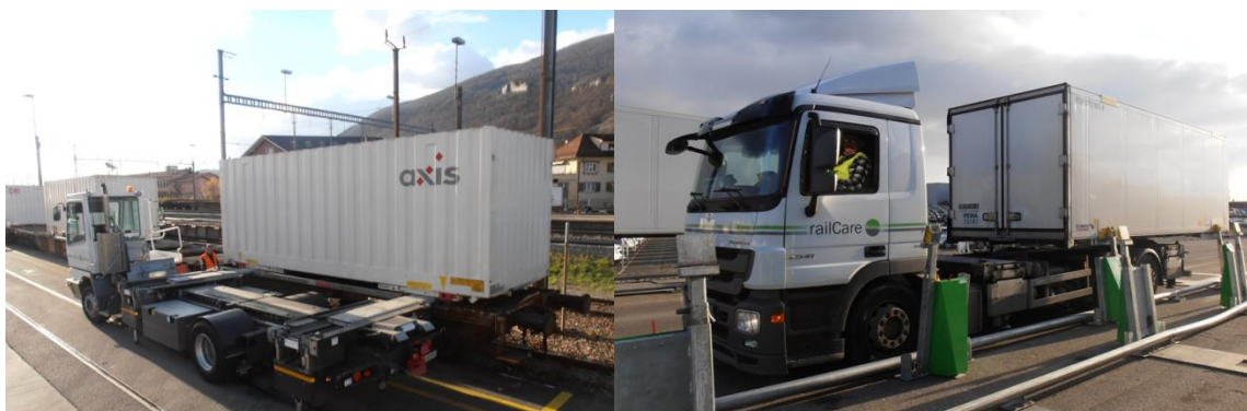
Figur 77. Innovatrains omlastningssystem 'ContainerMover' i Oensingen, Schweiz (Foto: Behzad Kordnejad, 2014).
