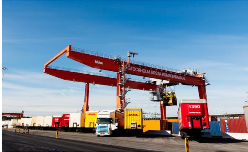
Figur 70. Topplyftning med portalkran i Årsta kombiterminal (Foto: Jernhusen)
