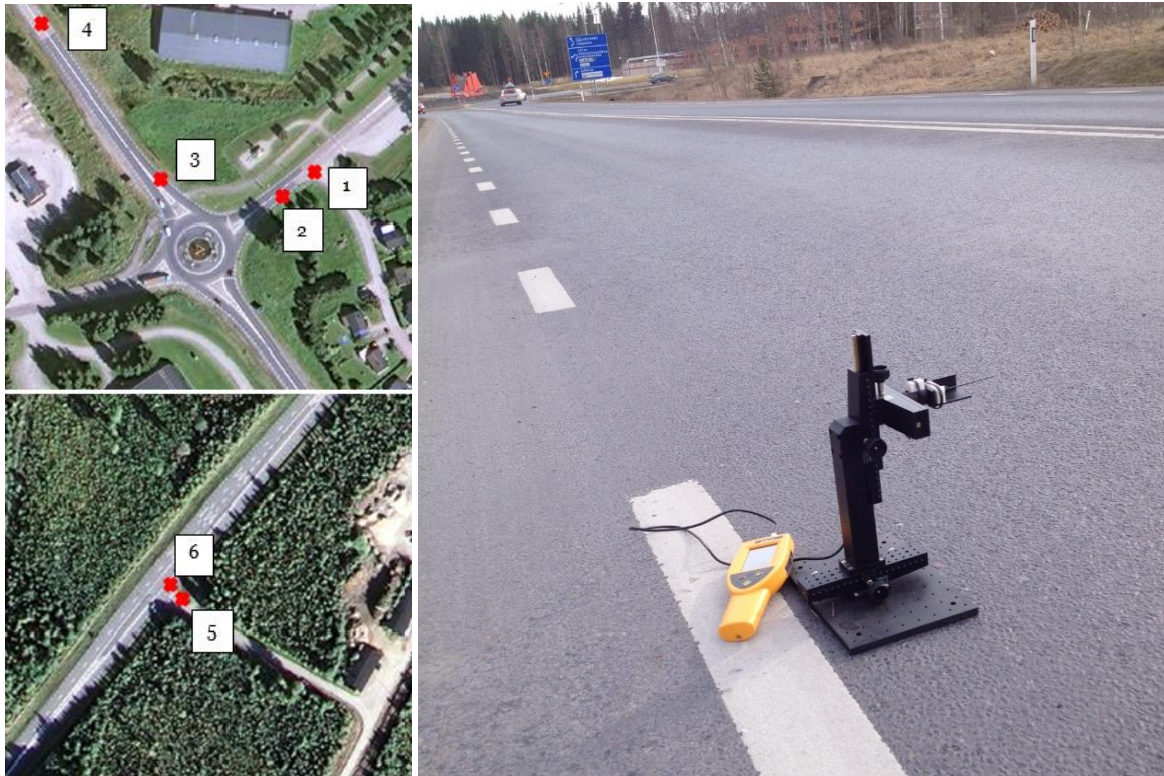
Figur 2 Placering av mätpunkter samt mätinstrument och stativ vid cirkulationsplats Smedjebacken väg 66
