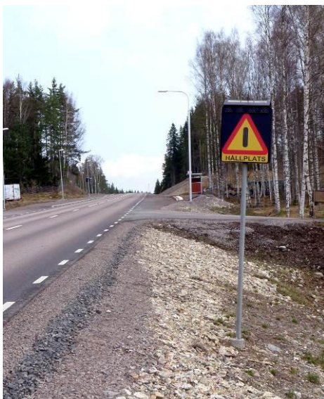
Figur 17: Väg 293 vid hållplats Brusala. ITS-lösning vid hållplats. April 2011. (Foto: Mikael Spjut, Svante Berg, Ramböll Sverige AB)
