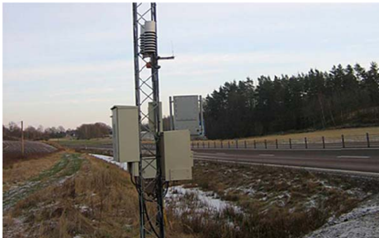
Figur 4. En av Trafikverkets 700 väderstationer (KTH, 2012). Yttemperatur, lufttemperatur och relativ luftfuktighet mäts vid alla stationer.
