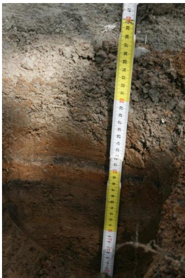
Figur 2. Provgrop i vägen. Man behövde inte gräva speciellt djupt innan man nådde naturligt lagrad morän
